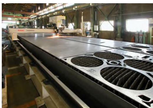
(清鋼材) 工場内観（2KWレーザー切断機）
